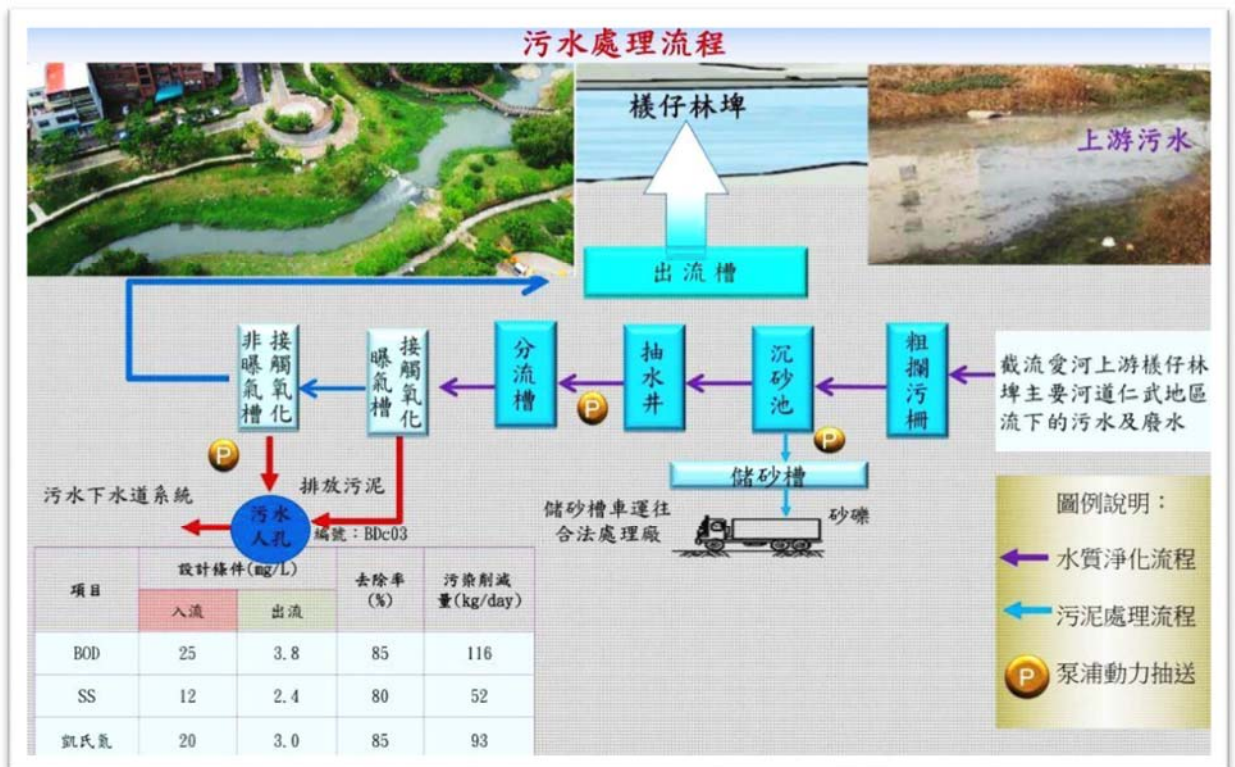
樣仔林埤現地水質處理流程、污染削減量及污泥零運輸
