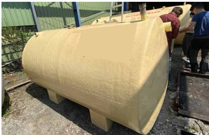
(a) FRP材質預鑄式污水處理設施
